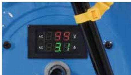
電圧：99V(電圧降下している)
